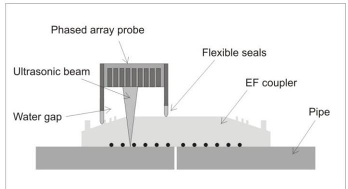
**FIG. 6 SCHEMATIC OF THE INSPECTION TECHNIQUE FOR EF JOINTS**
