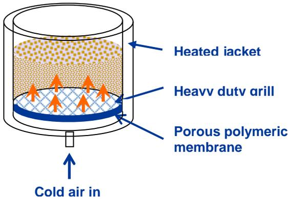
**FIG. 4 DIAGRAMATIC REPRESENTATION OF THE FLUIDISED SAND BED**
