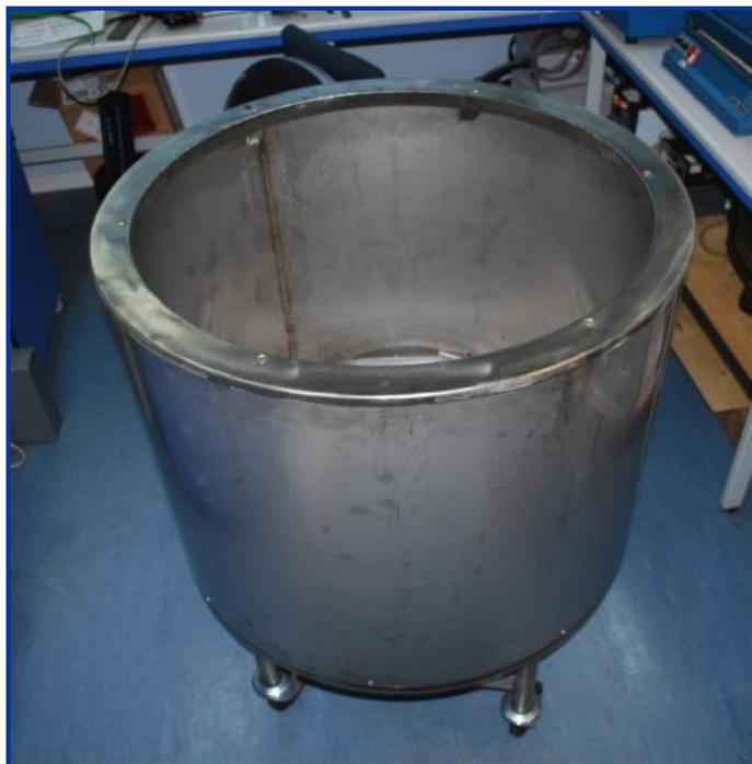
**FIG. 5 HEATED FLUIDISED SAND BED**
