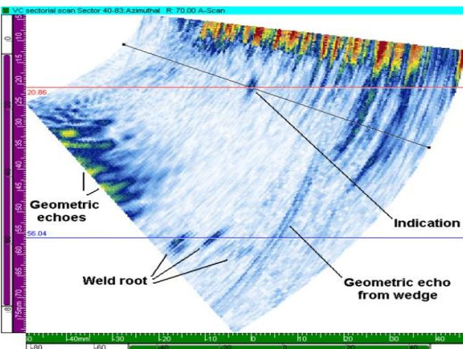
**FIG. 29 SMALL INDICATION IN POWER INDUSTRY PIPE JOINT**
