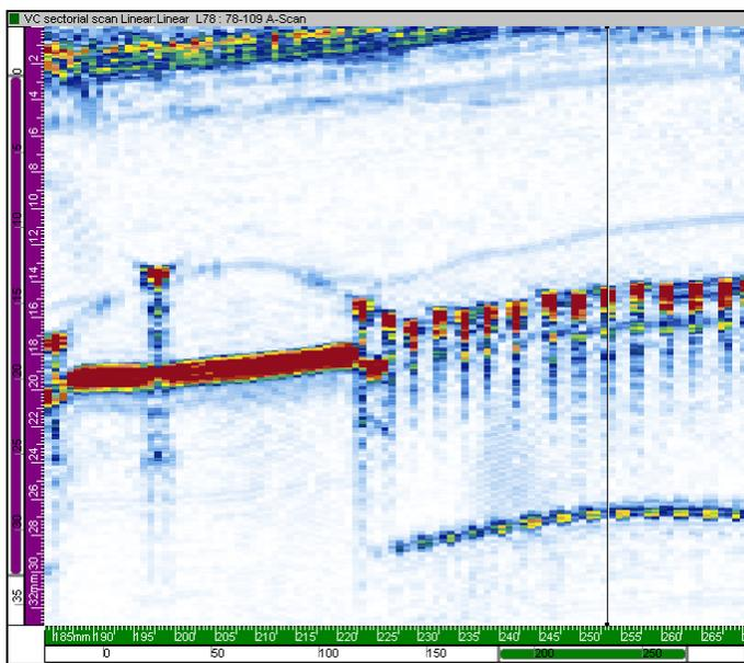
**FIG. 8 PHASED ARRAY ULTRASONIC IMAGE OF 180MM EF FITTING CONTAINING NO FLAWS**
