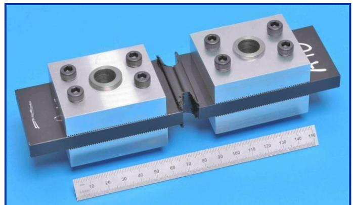
FIG. 22 TENSILE TEST SPECIMEN FROM A BF JOINT.
