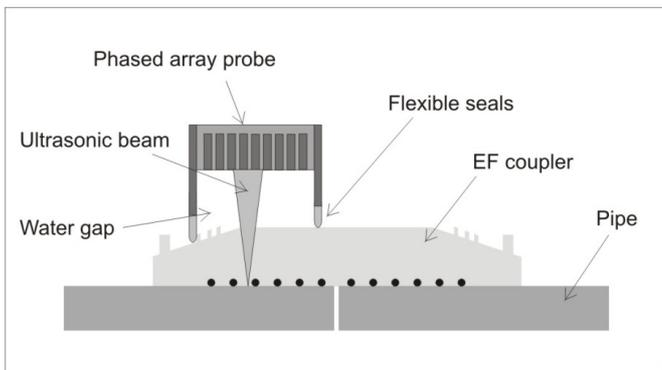
**FIG. 7 SCHEMATIC OF THE INSPECTION TECHNIQUE FOR EF JOINTS**
