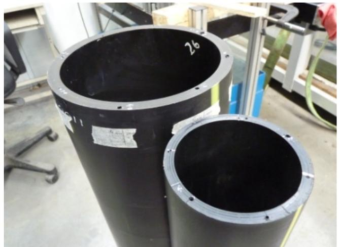
**FIG. 13 FLAT BOTTOM HOLES IN PIPE ENDS**
