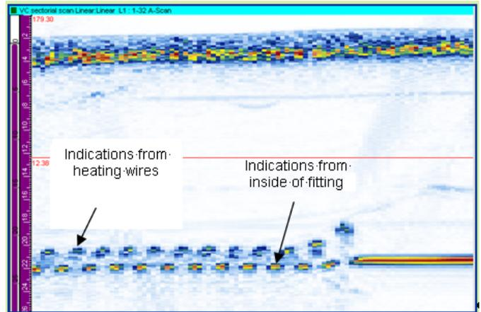
**FIG. 9 PHASED ARRAY ULTRASONIC IMAGE OF 180MM EF FITTING**
