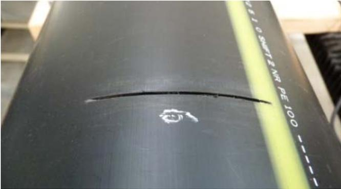
**FIG. 14 SLOTS IN PE PIPE**
