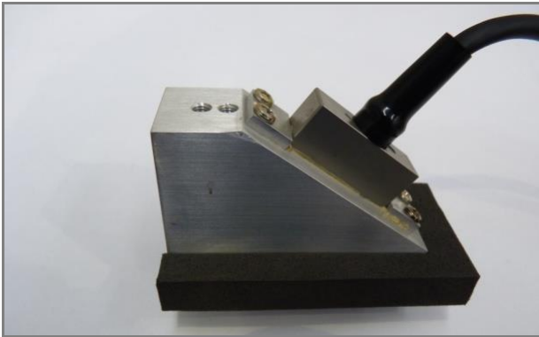
Figura 4. Conjunto de cuña de agua/sonda angular utilizado para inspeccionar uniones BF de pequeño diámetro.
