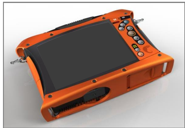
Figura 7. Diseño CAD del detector de defectos TestPEP.
