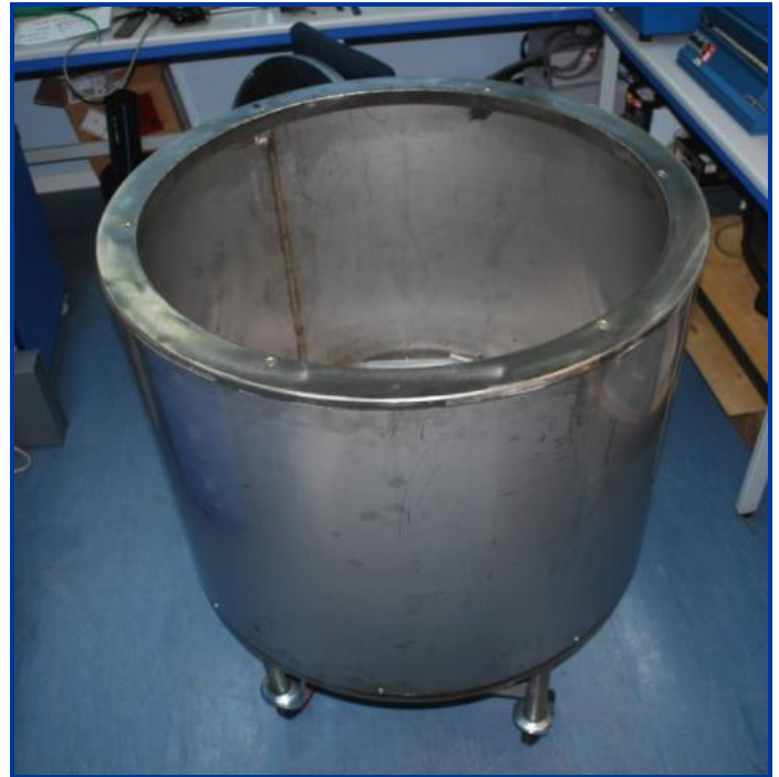
FIG. 5 CAMA DE ARENA FLUIDIZADA CALIENTE
