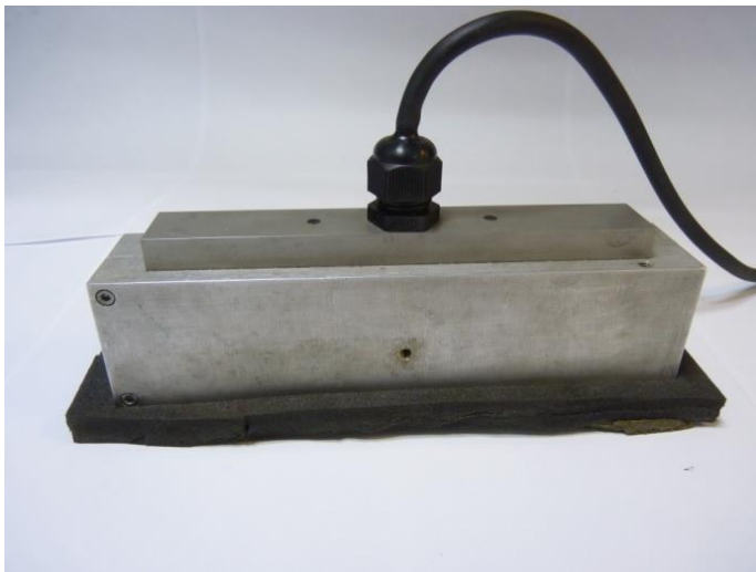
FIG. 7 CUÑA DE AGUA A CERO GRADOS UTILIZADA PARA INSPECCIONES EN EF
