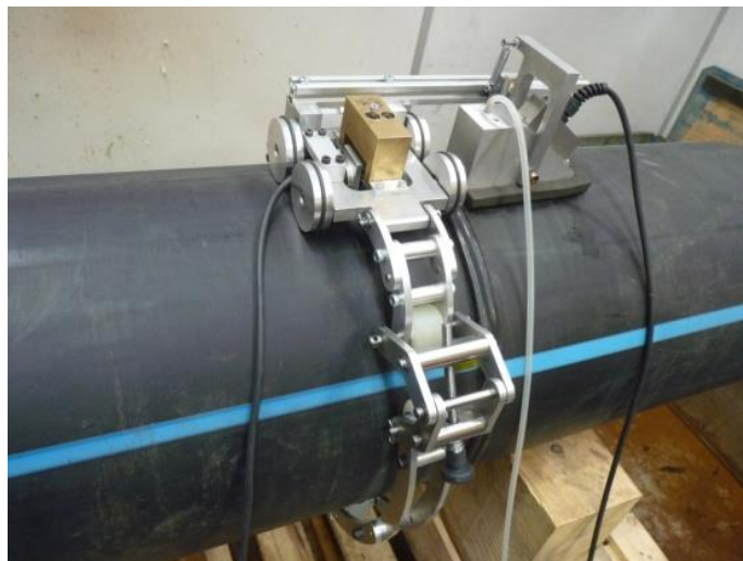
FIG. 26 ESCANER CON CADENA FLEXIBLE Y CABEZAL DE LA Sonda BF
