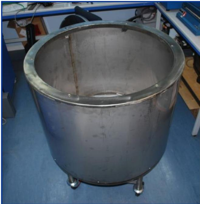
FIG. 5 LIT DE SABLE FLUIDISE CHAUFFE
