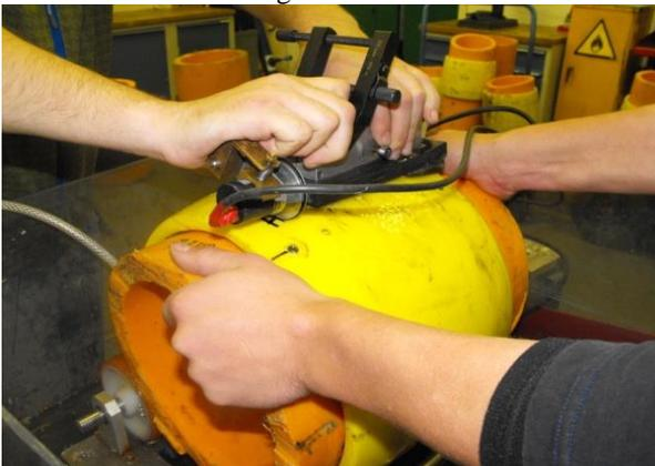
**FIG. 27 MANIPULATION MANUELLE DE LA SONDE POUR INSPECTER L'ÉCHANTILLON DU JOINT EF**
