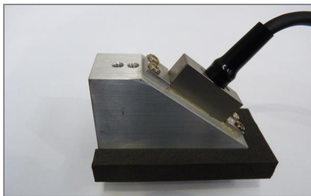
图 4.用于检测小直径热熔对接接头的倾斜水楔块/探头组件。
