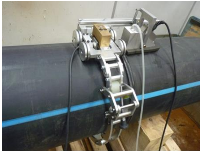
图 6. 热熔对接接头上的 TestPEP 检测原型系统，编码器安装在托架上。
