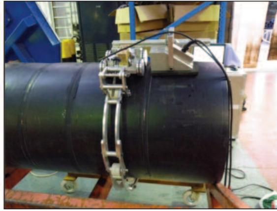
**Bild 9:** Prüfung einer 630-mm-stoßgeschweißten-Verbindung von PE-Rohren im Werk
